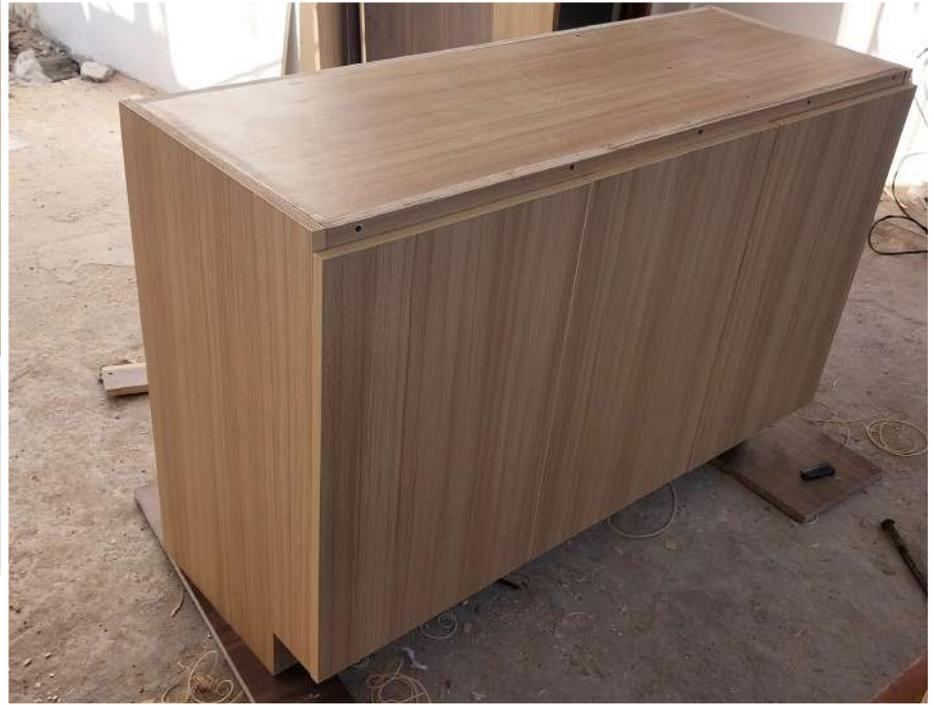
Meuble télé après reconstruction des côtés, du dessus, des supports et fabrication des portes
